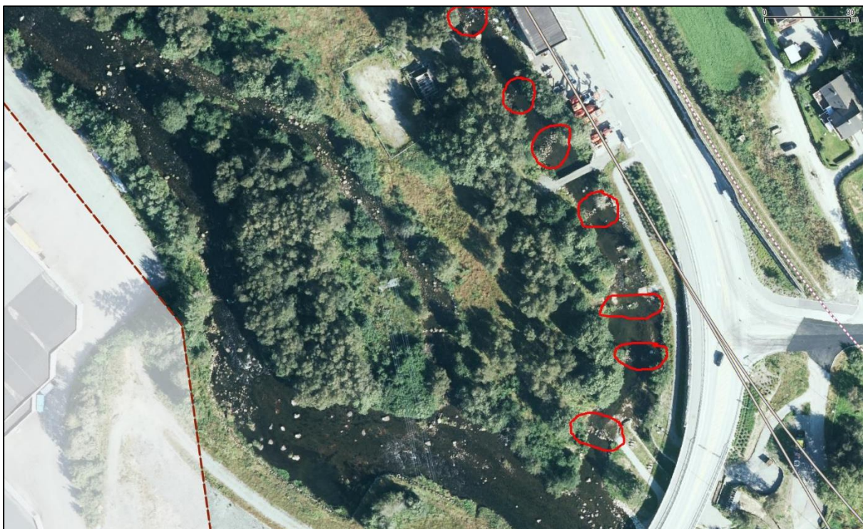
Figur 3.28. Det kan vurderes å fjerne steintersklene som er laget i elven for å få bedre fart på vannet, da det ligger mye sedimentert finmateriale i tilknytning til disse tersklene.
