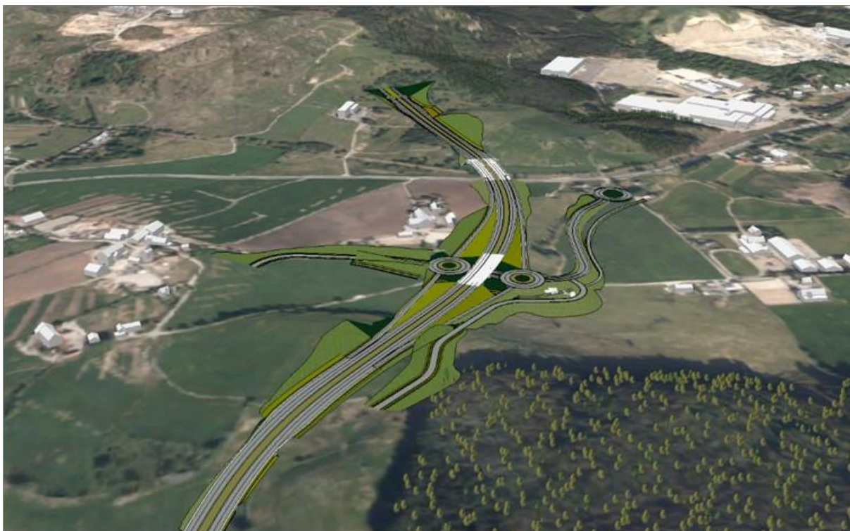
Figur 1.6: Kryssområde på Vagle med tunnelinnslag, sett mot øst. Tverrforbindelsen ligger i bro over rundkjøringene i «ruter-kryss».
